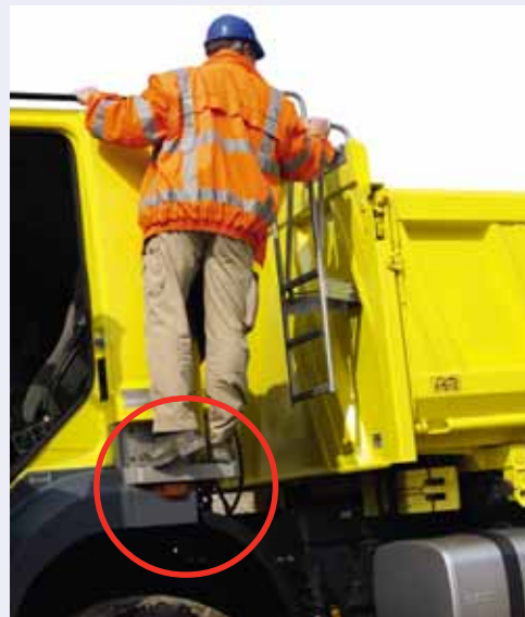
Det speciella fotstödet på anläggningsbilarna gör det lätt att inspektera lasten på flaket.
