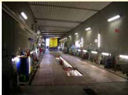
Verkstaden i Mora är 80 meter lång med tvätt, smörjgrop och serviceutrymme.
