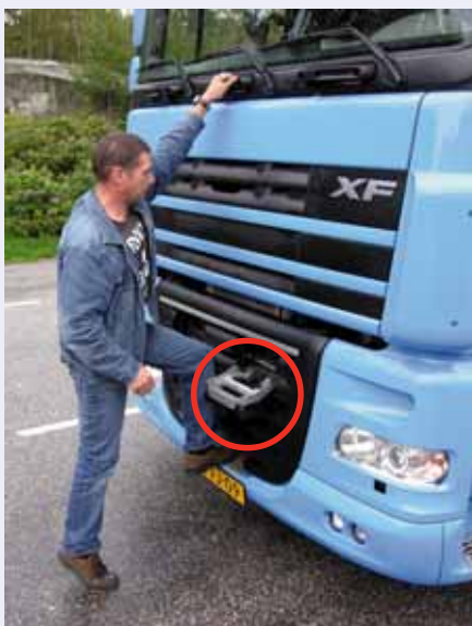
De utfällbara fotstegen i grillen underlättar rengöring av vindrutan.
